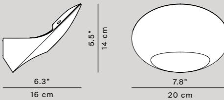
**Light source** D90NW / D90NC LED module 34W\* 2700 or 3000K CRI 90
